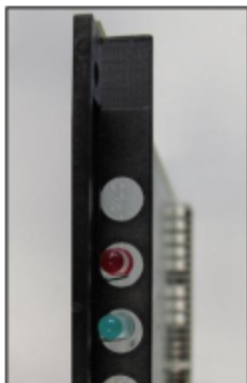
Figura 74: SLMAV8N, SLMAV24N – LED de la placa frontal
