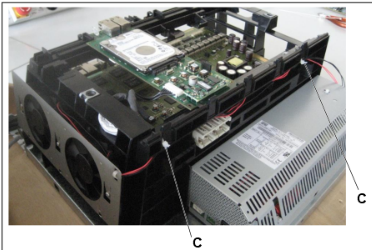
Figura 33: Kit de ventiladores (C39165-A7021-B310) para sistemas con backplane CUC
