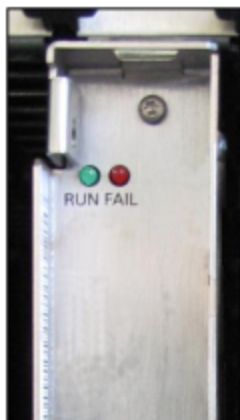
Figura 73: SLCN – LED en la placa frontal
