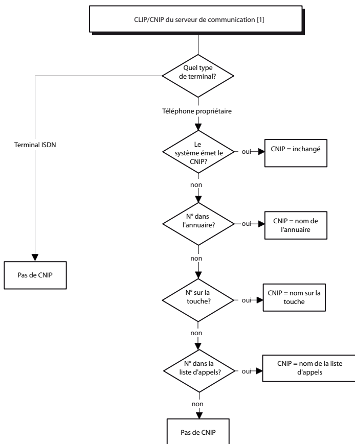
Fig. 34 Présentation du CLIP/CNIP d'un appel entrant sur le terminal
